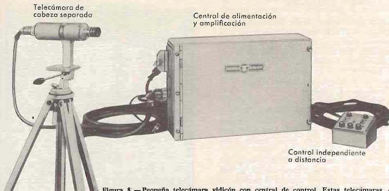
Figura 8.—Pequeña telecámara vidicón con central de control. Estas telecámaras, dada su mínima dimensión, están prácticamente formadas por el objetivo, el tubo de toma y las bobinas de foco electrónico y de deflexión del haz. Por tanto, todos los impulsos necesarios para la deflexión se generan en la central y se gobiernan por mando a distancia (Fernseh).
