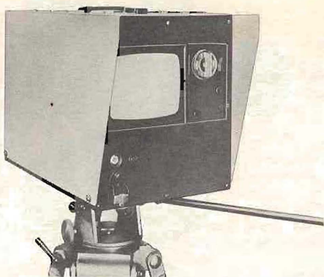
Figura 12. — Algunos tipos de telecámara están provistos posteriormente de un pequeño monitor, que permite al operador un control inmediato de lo que la telecámara está tomando. Este tipo es muy poco frecuente en TVCC, por cuanto, en general, los aparatos de toma televisiva industrial tienden a ser mandados eléctricamente, excluyendo la presencia de un operador.
