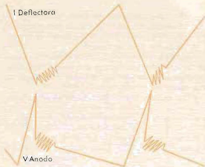
Figura 30. — Distorsión producida por las capacidades parásitas inducidas por las espiras de la bobina.
