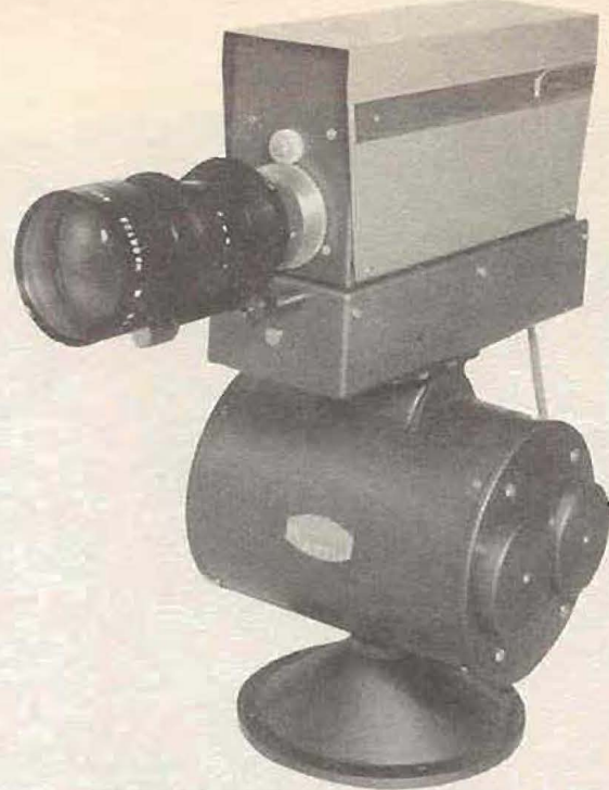
Figura 14.—Telecámara montada sobre dispositivo de giro, que permite variar el campo de toma en sentido vertical u horizontal. Es de advertir además el objetivo de enfoque variable («zoom»), mandado eléctricamente, que permite una aparente aproximación o alejamiento del sujeto (Magnet Marelli).
