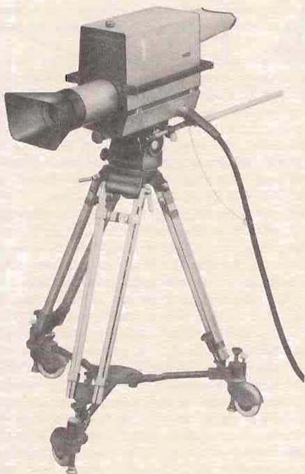
Figura 15.—Telecámara PLUMBICÓN para «escenas vivas» (imágenes en movimiento) de alta calidad (Philips EL8012).
