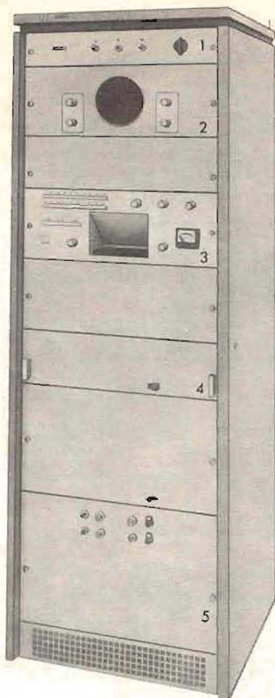
Figura 35. — Analizador de punto móvil (con diapositivas) para TV-Color (Philips).
