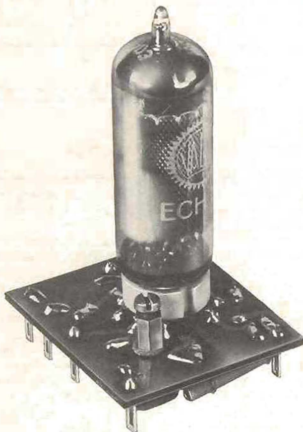
Fig. 14. — Aspecto de un separador-amplificador montado en un pequeño módulo de circuito impreso.
